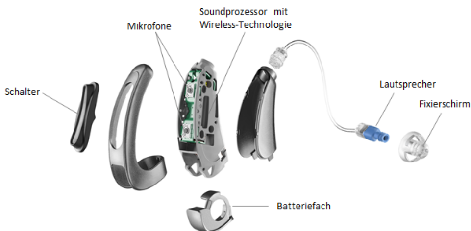
Abbildung 1: Wesentliche Komponenten eines Hörgerätes. (Quelle: KIND, Großburgwedel 2016)
